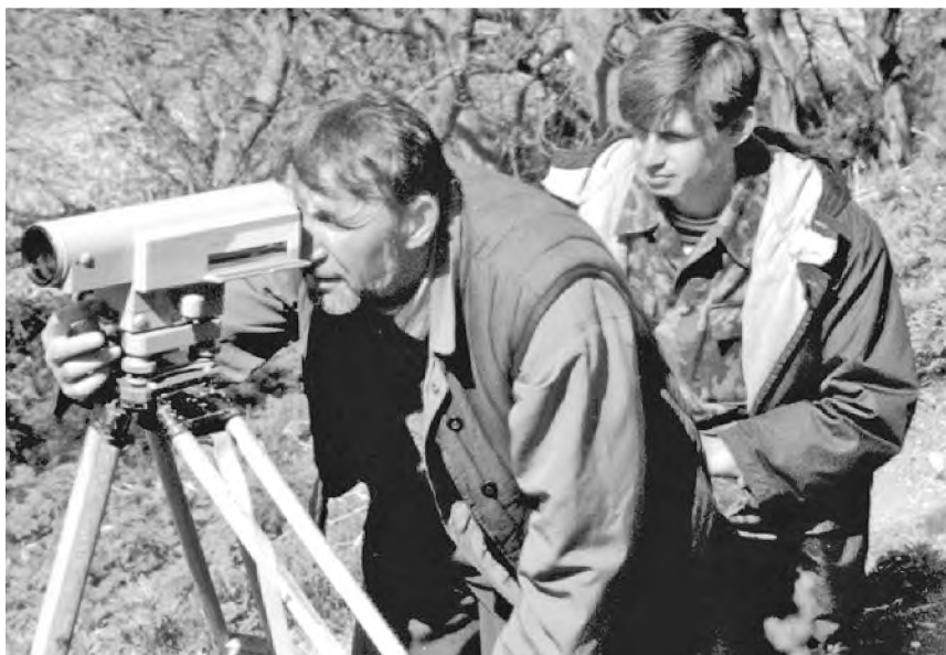
К. И. Евко (слева) и Д. И. Будилов выполняют нивелировку для топогеодезического обоснования крупномасштабных гидрографических работ в бухте Моховой с целью обеспечения безопасности мореплавания на акватории Петропавловского рыбного порта. Авачинская губа, 1998 г.
