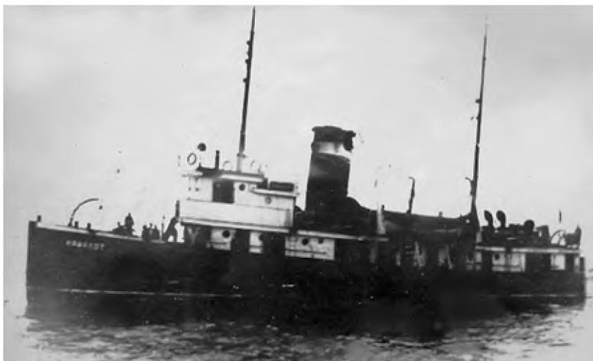
Морской паровой буксир «Кашалот» с деревянным корпусом. Первое судно Т. М. Кривоногова
