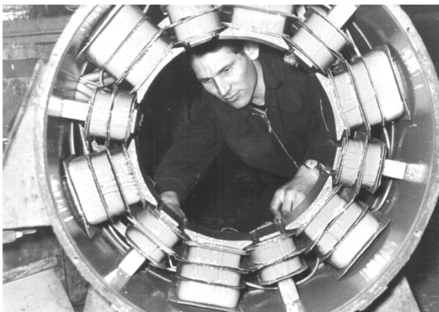
Идёт ремонт двигателя траловой лебёдки, 1959 г.
